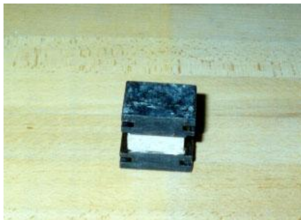
Εικόνα 8 : ΔΟΚΙΜΙΟ ΣΥΓΚΟΛΛΗΜΕΝΟ ΜΕ ΜΕΤΑΛΛΙΚΕΣ ΠΛΑΚΕΣ
