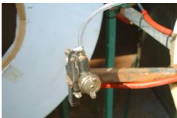
Εικόνα 14: Το πιστόλι ψεκασμού της συγκολλητικής ουσίας και οι αγωγοί αέρα (κόκκινο) και συγκολλητικής ουσίας (διαφανές)
