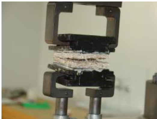
Εικόνα 39: Θραύση δοκιμίου μετά από τεστ αντοχής σε εγκάρσιο εφελκυσμό
