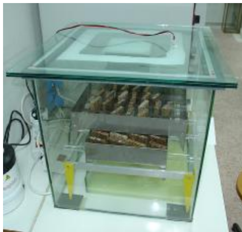
Εικόνα 32: Θάλαμος κλιματισμού για τον προσδιορισμό της ισοδύναμης υγρασίας
