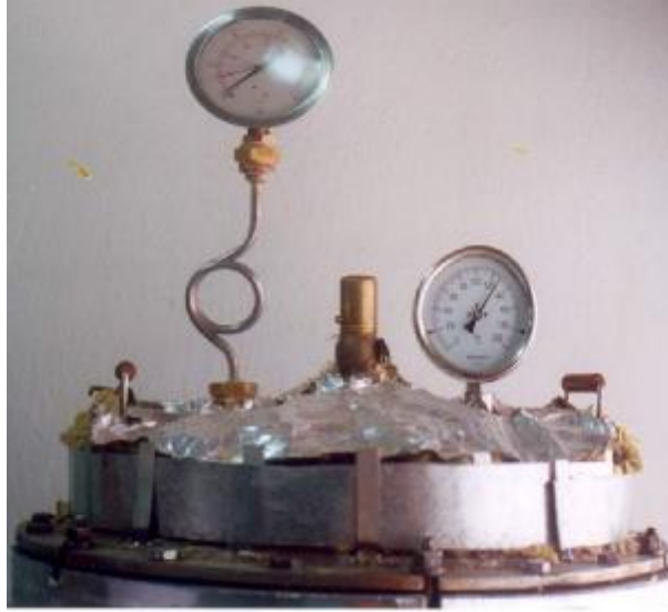
Εικόνα 21: Αντιδραστήρας (αριστερά: όργανο μέτρησης πίεσης, δεξιά: όργανο μέτρησης θερμοκρασίας, κέντρο: βαλβίδα ασφαλείας)
