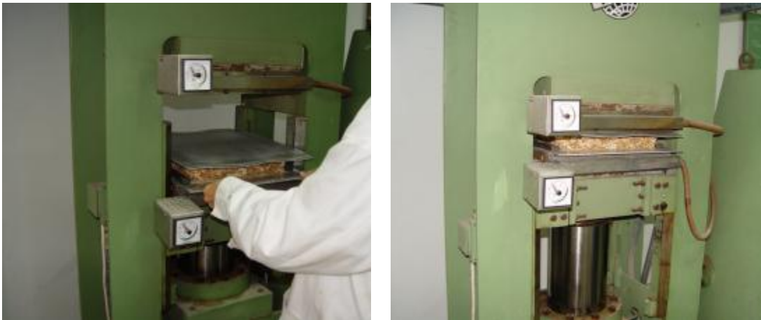
Εικόνα 34: Τοποθέτηση υλικού στην πρέσα - κλείσιμο πρέσας
