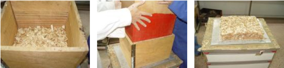
Εικόνα 33: Στρωμάτωση – Προπίεση – Στρωματωμένου υλικού
