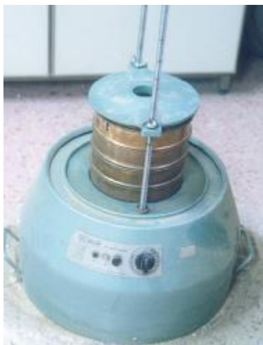
Εικόνα 26: Κόσκινο τύπου δονητή για κοκκομετρική ανάλυση
