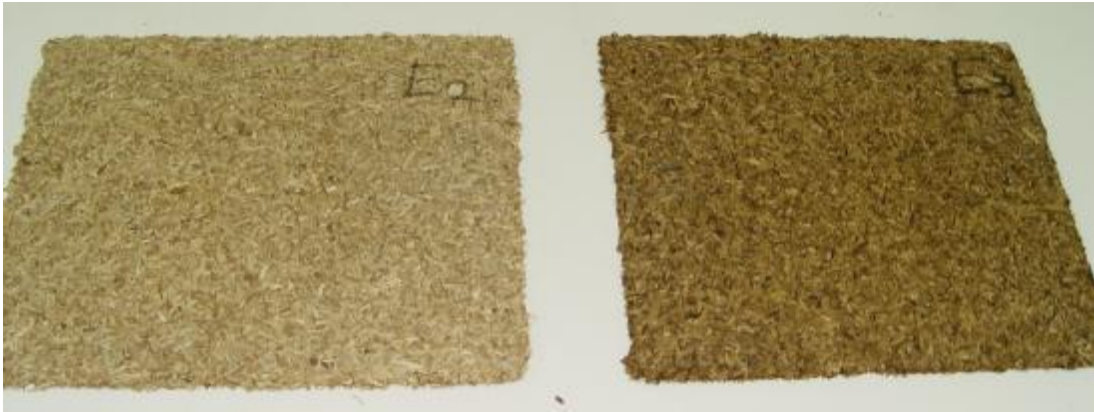
Εικόνα 42: Αριστερά: Μοριοπλάκα μάρτυρας, Δεξιά: Ανακυκλωμένη μοριοπλάκα
