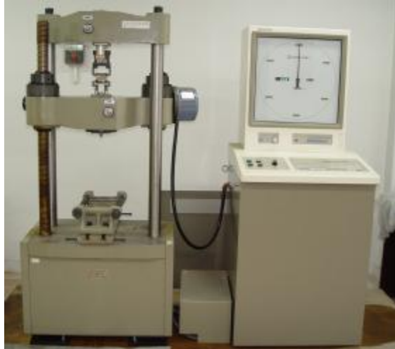
Εικόνα 27: Δυναμόμετρο για τον προσδιορισμό των μηχανικών ιδιοτήτων
