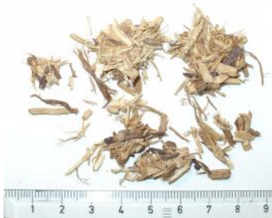
Εικόνα 41: Συσσωματώματα ξυλοτεμαχιδίων μετά την ανάκτησή τους με υδροθερμικό χειρισμό μοριοπλακών
