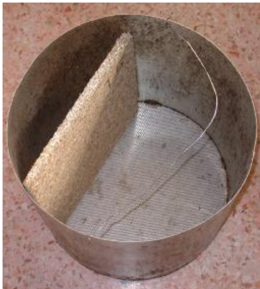
Εικόνα 35: Τοποθέτηση των προς υδροθερμικό χειρισμό μοριοπλακών στον διάτρητο κάδο
