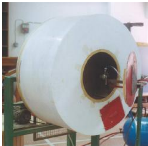
Εικόνα 12: Εμπρόσθια όψη του αναμικτήρα. Διακρίνεται το πιστόλι ψεκασμού της συγκολλητικής ουσίας και η είσοδος-έξοδος του υλικού
