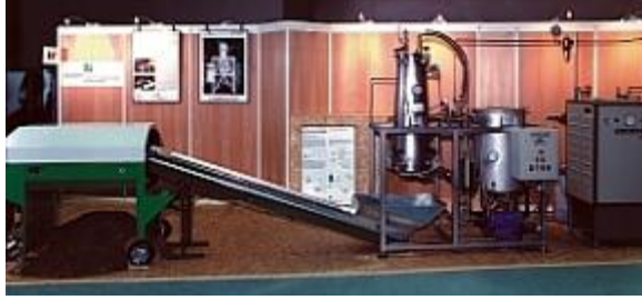
Εικόνα 3: Πιλοτική γραμμή ανάκτησης ξυλοτεμαχιδίων από ξυλοπλάκες με τη μεθοδολογία των Michanicki και Boehme στο Γερμανικό ερευνητικό Ινστιτούτο WKI ( http://www.wki.fraunhofer.de , 2003)
