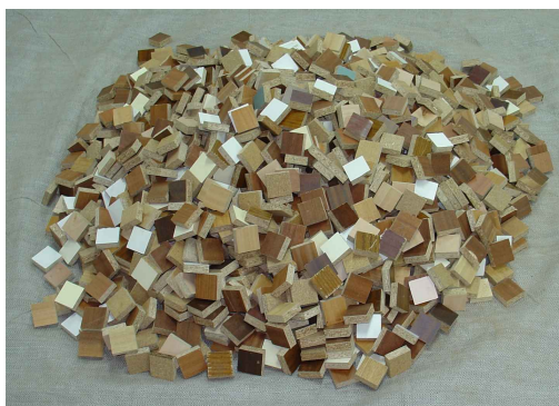
Εικόνα 42: Αναμειχθέντα δείγματα μοριοπλακών από παλιές ξυλοκατασκευές
