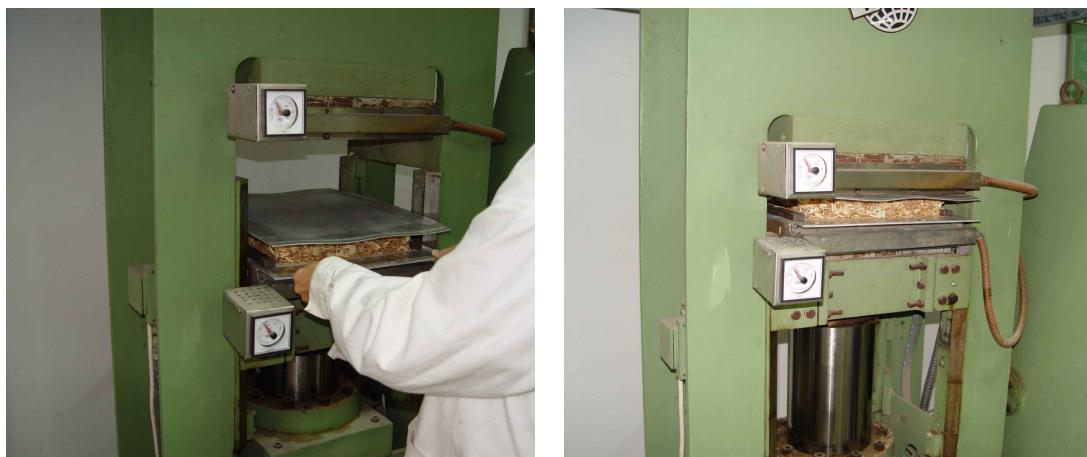
Εικόνα 31: Αριστερά: Τοποθέτηση υλικού στην πρέσα, Δεξιά: Κλείσιμο πρέσας
