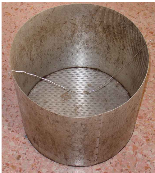
Εικόνα 21: Διάτρητος ανοξείδωτος κάδος τοποθέτησης του προς χειρισμό υλικού
