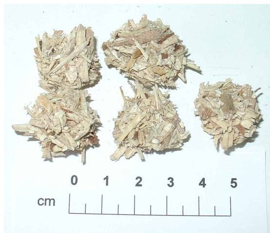
Εικόνα 25: Συσσωματώματα μετά τη διαδικασία του υδροθερμικού χειρισμού
