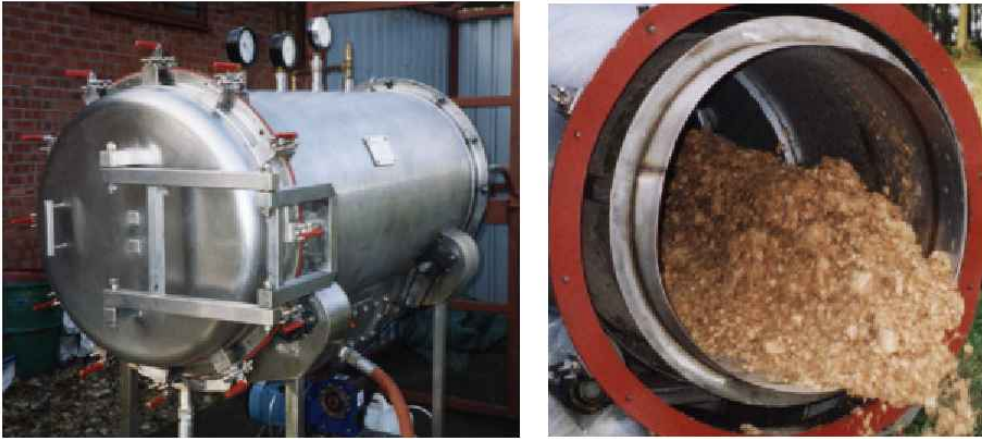
Εικόνα 11: Ο αντιδραστήρας ανάκτησης (αριστερά) και ανακτημένες ίνες (δεξιά) με τη διαδικασία Fibresolve ( http://www.envirofibre.co.uk , 2008)
