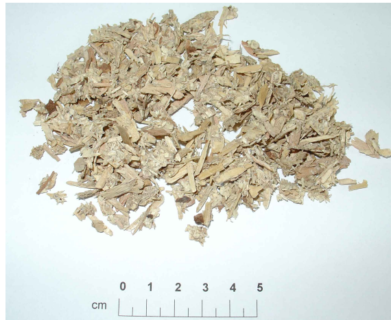
Εικόνα 54: Συσσωματώματα (>5mm) που προέκυψαν μετά από ανάκτηση ξυλοτεμαχιδίων μοριοπλάκας
