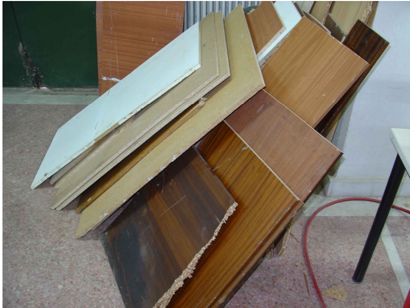
Εικόνα 40: Διαχωρισθείσες ξυλοπλάκες από παλιές ξυλοκατασκευές
