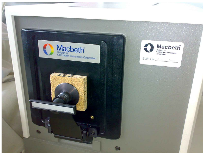
Εικόνα 52: Τοποθέτηση δοκιμίου για προσδιορισμό των χρωματικών μεταβλητών
