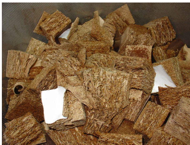
Εικόνα 43: Δείγματα μοριοπλακών μετά τη διαδικασία ανάκτησης
