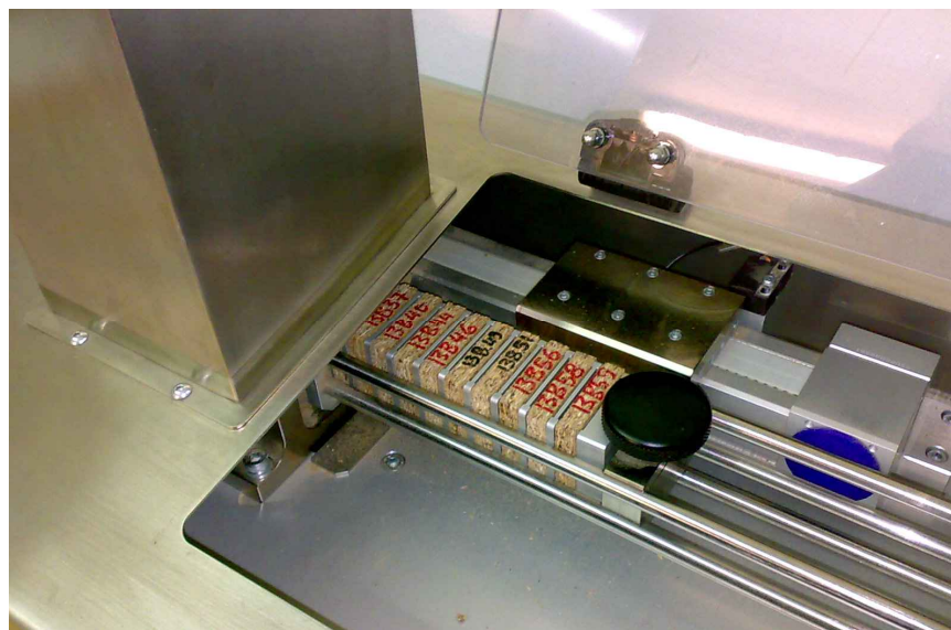
Εικόνα 50: Τοποθέτηση δοκιμίων για προσδιορισμό του προφίλ πυκνότητας
