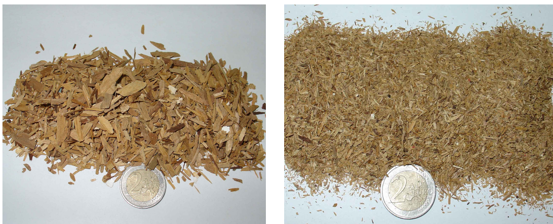
Εικόνα 28: Ανακτηθέντα ξυλοτεμαχίδια μετά τον υδροθερμικό χειρισμό (αριστερά: υλικό μεσαίας στρώσης, δεξιά: υλικό επιφανειακών στρώσεων)
