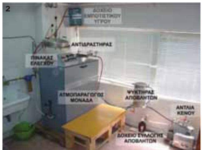
Γενική άποψη της πιλοτικής διάταξης ανάκτησης πρώτων υλών (με χρήση υδροθερμικών χειρισμών) από ξυλοπάκες
