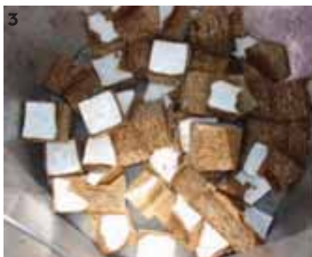
Εικόνα 2: Το υλικό που προκύπτει μετά τον υδροθερμικό χειρισμό (αριστερά) και μετά την αφαίρεση των επικαλύψεων (δεξιά) Εικόνα 3 και 4: Ινοπάκες πριν τη διαδικασία ανάκτησης (Α) μετά τον υδροθερμικό χειρισμό (Β) και μετά από αποτριβή (Γ)
