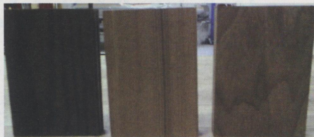
Εικ. 1: Δείγματα 3 τύπων τροποποιημένης ξυλείας
